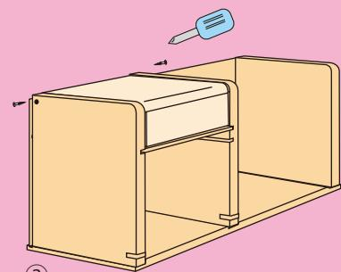
底板のみぞに左右側板、後板を接着し、垂直になるようにします。みぞが左側になるように中板を接着します。(左側板はみぞがあります。)
