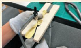
② 大きめに金切ばさみで切りまわす。曲線部分はすり板の上で押さえて、金工糸鋸で切断します。
